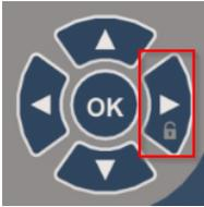
Die Tastensperre des ZPW126-10 wird aktiviert, sobald sich das Display abschaltet. Um die Tastensperre aufzuheben, drücken Sie auf die Navigationstaste rechts und anschließend auf die Taste OK.
